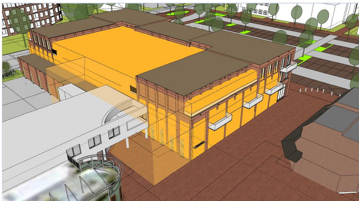
Figuur 2 3D model van de nieuwbouw met in geel de maximale bouwmogelijkheden volgens het bestemmingsplan
